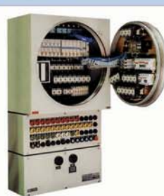
Комбинированный шкаф системы контроля и управления Серии 8225 Обозначение взрывозащиты: 1Exdem[ia/ib]IIC/T6
